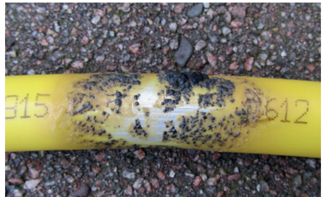
Afb. 5. De aluminium laag voorkomt uitstromen van gas bij een beginnende brand.
