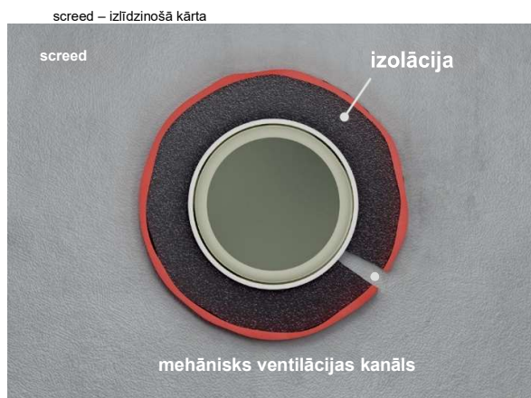
41.att.: Mehānisko vibrāciju izplatīšanās caur bojātu caurules izolāciju.
