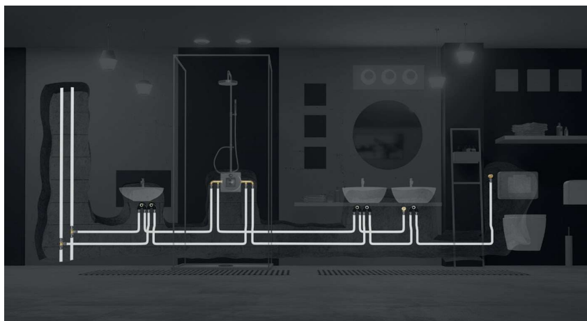
43.att.: Secīga ūdensapgādes sistēma.
