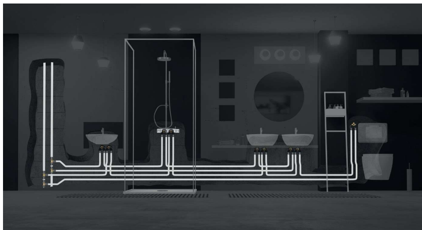
44.att.: Cilpveida ūdensapgādes sistēma.
