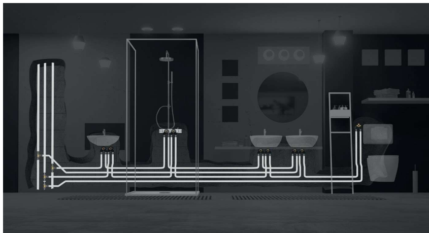
45.att.: Cilpveida ūdensapgādes sistēma ar cirkulācijas savienojumu.
