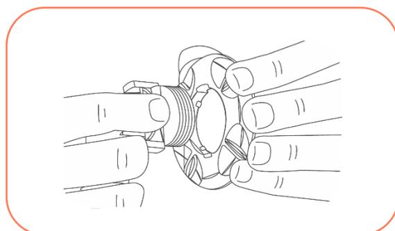
4º Rosqueie a porca no acoplamento. Retire o tampão da ponta do terminal (espigão) e acople a mangueira da máquina de lavar.
