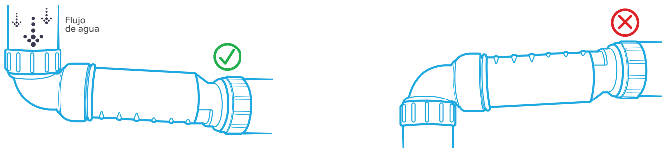
Figura 6. Cuando se instala horizontalmente, las nervaduras deben estar en la parte inferior para garantizar un correcto funcionamiento.
