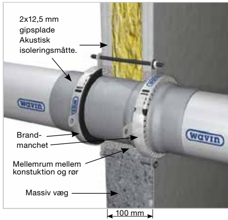
Lige gennemføring med eller uden muffe.
