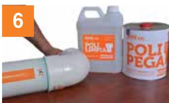
**6** Una el extremo liso del tubo con la campana del otro tubo o accesorio y de un cuarto de vuelta asegurándose de un buen acoplamiento y manteniendo firmemente la unión por 30 segundos. Quite el exceso de soldadura de la unión y deje solamente el cordón de soldadura entre los extremos a unir.
