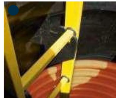
Für die Arretierung der Steigleiter wird die Leiter in der Steigleiteraufnahme im Konus eingerastet. Hierzu ist die Steigleiter in die Aufnahme zu drücken, bis sie beidseitig fest einrastet.
