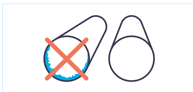
Figura 46: Antes de la instalación, es necesario comprobar que las tuberías no presenten daños ni contaminación.
