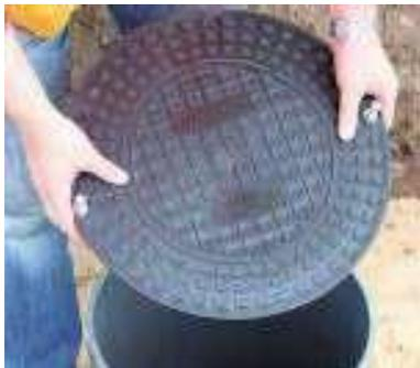
Das Schachtrohr ist ggf. entsprechend der Einbautiefe zu kürzen und zu entgraten. Die Außensechskantschrauben (M 8) sind mit einem Innensechskantschlüssel (13 mm) zunächst so weit zu lösen, dass die Abdeckung auf das Schachtrohrende aufgesetzt werden kann.
