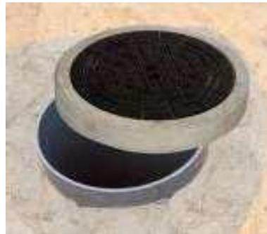
Die Kombiabdeckung ist vollflächig und ohne Punktlasten in das Ortbetonauflager einzubetten. Hierbei ist darauf zu achten, dass das Schachtrohr min. 20mm in den Betonrahmen der Kombiabdeckung greift. Je nach Einbausituation kann ein Höhenausgleich von bis zu 50mm mit der Kombiabdeckung vorgenommen werden.
