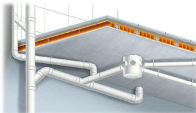
Instalação tradicional: a propagação da zona de choque transmite diretamente o ruído para a estrutura.
