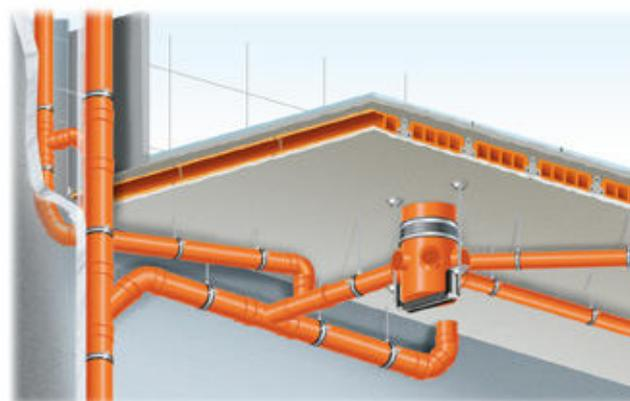
Instalação Amanco Silentium® PVC: a propagação da zona de choque é drasticamente reduzida através das abraçadeiras e amortecedores acústicos, não transmitindo o ruído à estrutura.
