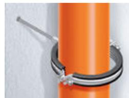
Introduza rosqueando a Abraçadeira Amanco Silentium® na outra ponta da barra de rosca sem-fim. Nivele para acomodar o tubo e trave através dos parafusos acoplados;
