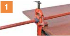
Colocar el tubo en un tornillo de banco o mordaza sin exagerar el ajuste para evitar ovalamientos, pues esto provocaría una rosca imperfecta. Proteger el tubo de PP con un tramo de Polietileno y/u otro medio.
