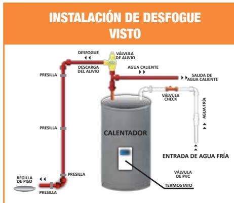
Se recomienda que para la conducción de agua caliente domiciliar, generada por un calentador de agua / calefón o termotanque, se empleen tubos de presión nominal 1.0MPa a una presión máxima de 0.4MPa.
