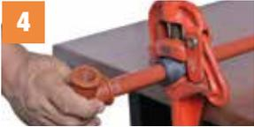
Prevea la limpieza de las rosas y compruebe en seco el roscado del tubo con el accesorio a instalar.
