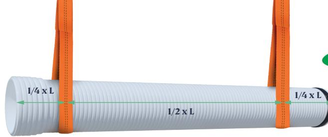
Figura 5.9. Alzaje de la tubería
