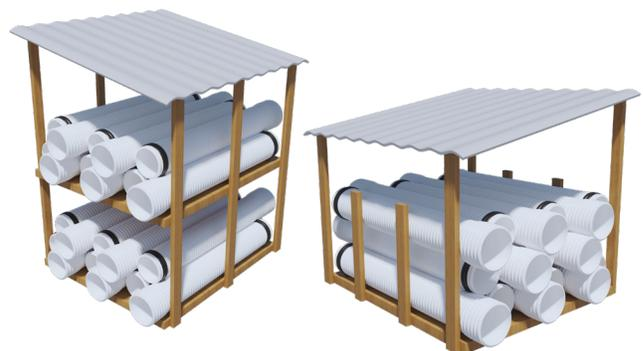
Figura 5.14. Protección contra la radiación UV
