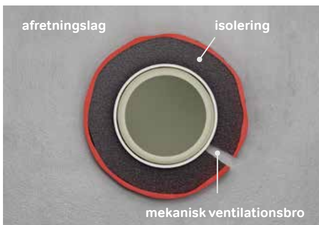
Fig. 41: Mekanisk vibrationstransmission gennem defekt rørisolering.
