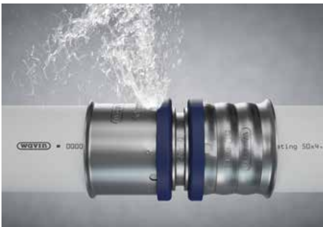
Fig. 16: Funktionen GARANTERET UTÆT i trykprøvningen afslører den ikke-pressede fitting ved hjælp af udstrømmende vand.
