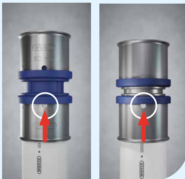
Fig. 15: IN4SURE™ muliggør en visuel kontrol af, om røret er indført tilstrækkeligt langt i fittingen.
