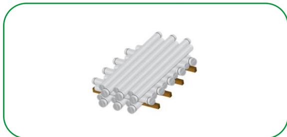
Realizado por meio da utilização de cruzamento longitudinal dos tubos para amarração das pilhas, sem a utilização de suportes laterais, utilizando sarrafos de madeira no sentido transversal a primeira camada espaçada de 1,5 m.
