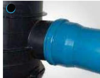
Das Spitzende des Straßenablaufs ist mit dem vorgesehenen Rohrsystem zu verbinden. Hierbei wird die Muffe des Rohrsystems auf das Spitzende DN/OD160 geschoben. Die Verlegeanleitungen des Rohrherstellers sind zu berücksichtigen.
