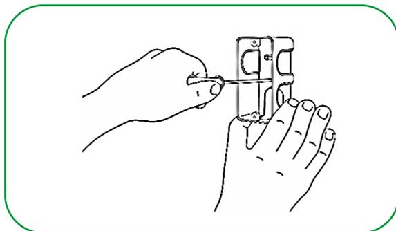
furação e fixe a caixa de luz na parede com o auxílio de bucha e parafuso, utilizando o furo central no fundo da caixa de luz para fixação;
