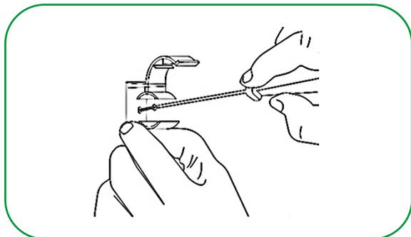
3° Inicie a montagem do sistema, fixando inicialmente os componentes (adaptador, acabamento) na caixa ElectroAmanco,
