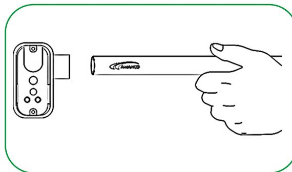
6° Fixe o eletroduto ElectroAmanco nas abraçadeiras até a próxima caixa a instalar;
