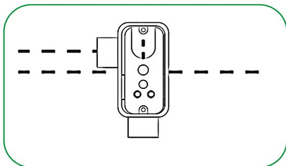
2° Faça a furação dos pontos onde serão instaladas as abraçadeiras, e com o auxílio de buchas e parafusos, instale as abraçadeiras, respeitando a distância média de 1,5 metro entre elas:
