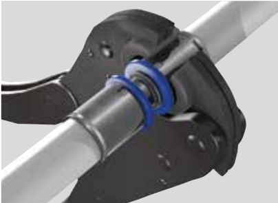
25. ábra: A présfóák pozicionálása a Tigris K1 és a Tigris M1 csőköötő idomokra
