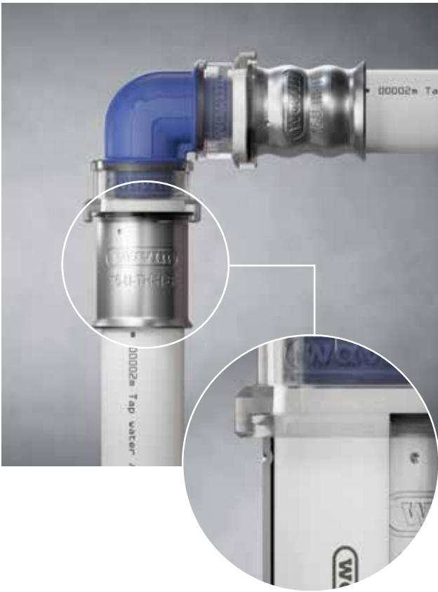
13. ábra: A PIPEGRIP szilárdan a megfelelő helyzetben tartja a csövet, hogy felszabadítsa az egyik kezet a préselő eszköz használatához.
