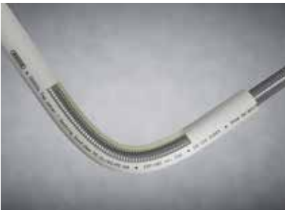
26. ábra: A cső meghajlítása hajlítórúgóval
