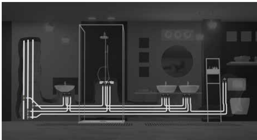
44. ábra: Hurkos szerelés cirkulációs csatlakozással
