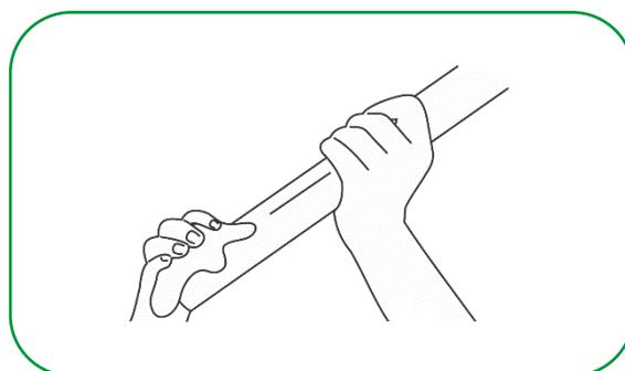
3º Aplicar com pincel uma camada uniforme de Adesivo Plástico PVC Amanco Wavin na parte interna da bolsa da conexão e uma camada igual na parte externa do tubo. Para tubos e conexões igual ou acima de DN75 e para o sistema Quickstream, utilizar o adesivo de PVC para grandes diâmetros (vermelho) Amanco Wavin.
