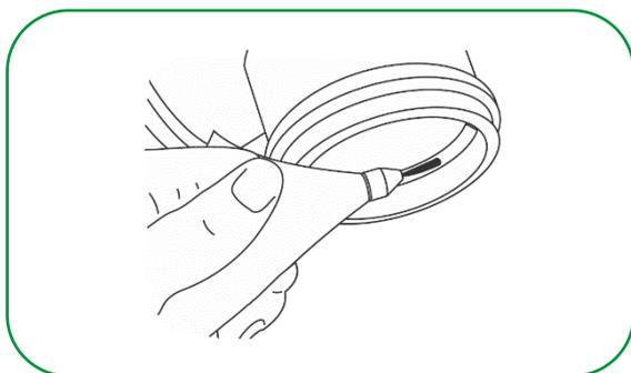
5º Introduza a ponta do tubo ou conexão, forçando o encaixe até o fundo da bolsa, depois recua o tubo aproximadamente 1 cm, para permitir eventuais dilatações térmicas.
