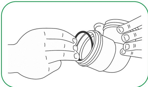
4º Aplique uma camada de Pasta Lubrificante Amanco Wavin na ponta do tubo e na parte visível do Anel de Vedação;
