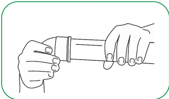
5º Verificar a formação de um cordão de solda preenchendo a bolsa e a ponta, remover o excesso de Adesivo Plástico PVC e deixar secar. Aguardar o tempo especificado para submeter o sistema ao teste de pressão hidráulica.
