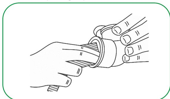
2º Para tubos e conexões de PVC, limpar as superfícies lixadas com Solução Preparadora Amanco Wavin, eliminando as impurezas que podem impedir a ação do Adesivo Plástico Amanco Wavin. Esta ação prepara o material para a soldagem.
