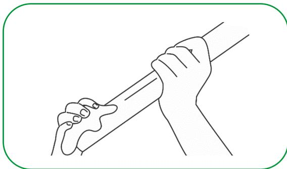
3º Aplique uma camada uniforme e sem excessos de Adesivo Plástico CPVC.
