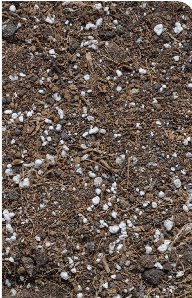
Liegen in der Örtlichkeit keine geeigneten Böden vor oder können diese nicht auf andere Weise bereitgestellt werden, ist ein Substrat zu verwenden. Empfohlen werden alle Substrate welche die Anforderungen an nicht überbaubare Pflanzgrubensubstrate nach den FLL-Empfehlungen für Baumpflanzungen Teil 2: Standortvorbereitungen für Neupflanzungen, Pflanzgruben und Wurzelraumerweiterung, Bauweisen und Substrate (FLL 2010) erfüllen (FLL 1-Substrate).
