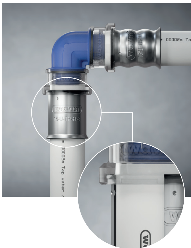
Kuva 14: PIPEGRIP pitää putken tukevasti paikallaan, jotta puristustyökalun käyttöä varten on vapaat kädet.
