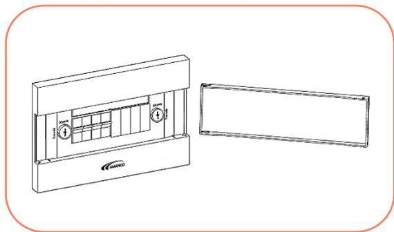
10º Caso não sejam utilizados todos os espaços para disjuntores, cubra os vazios com as tampas de disjuntor. Cole os adesivos identificando os circuitos dos disjuntores.
