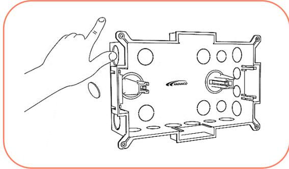
2° Faça o chumbamento do Quadro de Distribuição na parede e em seguida conecte os eletrodutos;
