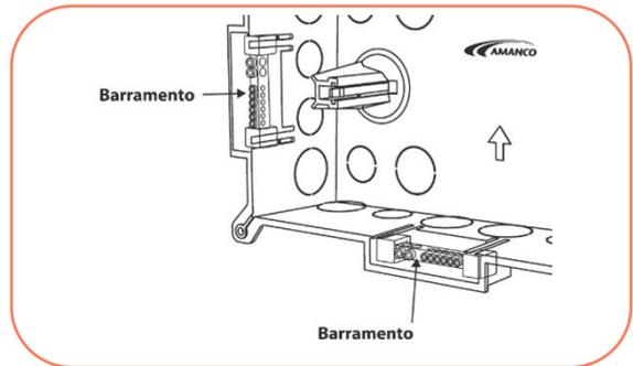
7° Faça a instalação elétrica conectando os cabos elétricos de neutro e terra aos barramentos, e os disjuntores aos circuitos correspondentes;
