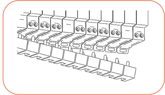
5° Encaixe o trilho dos disjuntores já montados nas torres do corpo do Quadro de Distribuição. Monte o suporte dos barramentos neutro e terra no corpo metálico;
