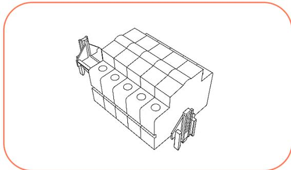
4° Conecte os disjuntores usando pente de fase ou o próprio cabo de alimentação fase (sistema de jumping);
