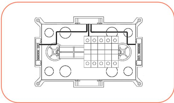
8º Fixe o porta-tampa no corpo do Quadro de Distribuição, parafusando-o conforme indicado na figura abaixo;
