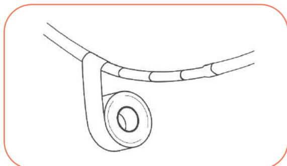
3° Cubra a parte a ser isolada completamente exercendo uma leve pressão sobre o material.
