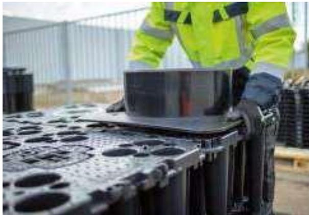
Es können sowohl die kreisförmigen als auch die kreuzförmigen Markierungen freigeschnitten werden. Kennzeichnungen zeigen die Schnittkante.
