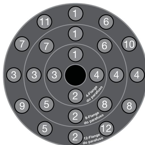
Figura 4: Padrões para a fixação do parafuso do flange.
