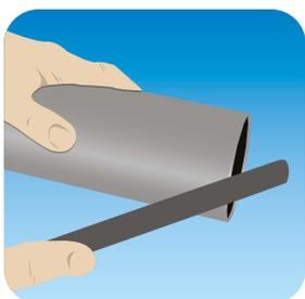
As rebarbas e limalhas podem ser obstáculos para o contato apropriado entre a tubulação e as conexões e podem pôr um esforço indevido na montagem, deste modo remove-as do exterior e interior da tubulação. Uma ferramenta ou lima de chanfro são adequadas para essa finalidade. Um chanfro leve no final da tubulação facilita a entrada da tubulação na bolsa da conexão, e minimiza as possibilidades de que o adesivo escorra dentro da conexão.
