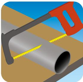
A tubulação CPVC Amanco Corzan® pode ser cortada facilmente com uma serra de metal, cortador circular para tubulação plástica, serra elétrica, ou uma serra de dentes finos. Para assegurar que a tubulação seja cortada corretamente, deve-se usar esquadros ao cortar com a serra. Cortar a tubulação em ângulo reto.
