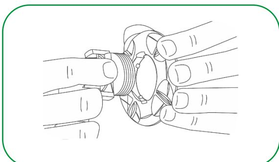
4º Rosqueie a porca no acoplamento. Retire o tampão da ponta do terminal (espicão) e acople a mangueira da máquina de lavar.
