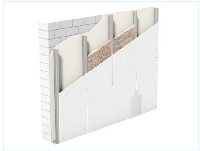
Obrázek 24: Konstrukce předstěny před masivní stěnou (zdroj: Knauf)
