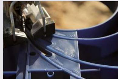
Na definovaných místech se osazují vstupní desky, ve kterých se ještě upravuje na předem označených místech (značka pilka) průměr nátokového potrubí. Pro tyto úpravy je vhodné používat přímočaré el. pilky s dostatečně dlouhým listem.
