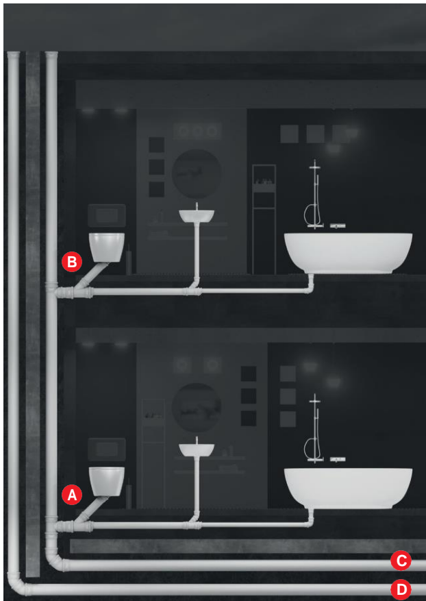
11.att.: Piemērs: Minimālais slīpums notekūdeņu caurulēm.
