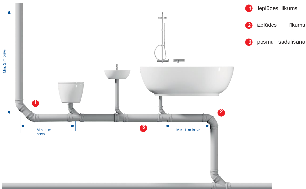
13.att.: Notekcaurules novirzījums > 2 m ar caurules posmiem bez savienojuma vietām.
