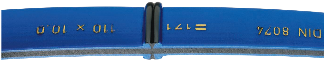
Wavin TS DOQ ® Rohr nach erfolgter Heizelementstumpfschweißung
