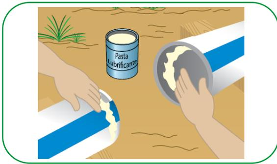
Introduzir a ponta do tubo na bolsa observando as marcações, que indicam quanto a ponta deve ser introduzida na bolsa.
