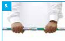
5. Inserte y realice 1/4 de giro para asegurar una buena distribución interna de la soldadura.
