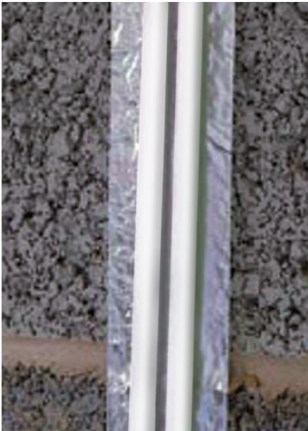
Afb. 5.21: Metaaltape kan gebruikt worden als hulpmiddel bij elektronische buisdetectie.
