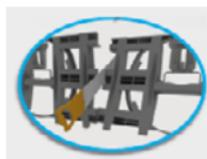
Veiller à ce que le bord arrondi de la demi-plaque soit positionnée dans le coin de l'ouvrage (et non le bord coupé) ou, selon la longueur de côté, placer la demi-plaque entre deux plaques non coupées.
