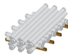
Realizado por meio da utilização de cruzamento longitudinal dos tubos para amarração das pilhas, sem a utilização de suportes laterais, utilizando sarrafos de madeira no sentido transversal a primeira camada espaçada de 1,5 m.
