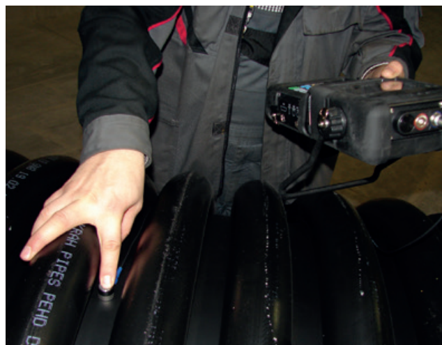
Mätning av rörens vägg tjocklek
