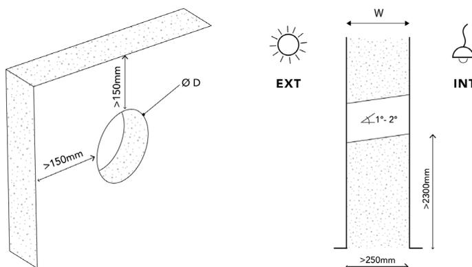
L'unità risulta compatta e di semplice installazione. Si posiziona a parete ad un'altezza minima di 2,3 m dal pavimento (prendendo come riferimento l'estremità inferiore del condotto). Il diametro del foro da realizzare dipende dal modello: 100 mm per SOLO 30A-2 e 160 mm per SOLO 60A e 60A-2.
