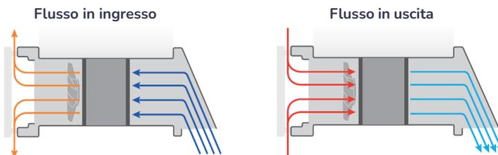
Le unità SOLO funzionano a flusso alternato. Nel primo ciclo di funzionamento l'unità espelle l'aria dell'ambiente per 70 secondi facendola passare attraverso lo scambiatore in materiale ceramico che accumula calore. Al termine di questo ciclo, il ventilatore inverte automaticamente il flusso, immettendo aria esterna pulita nel locale riscaldandola preventivamente grazie all'attraversamento dello scambiatore che in questa fase cede calore.
