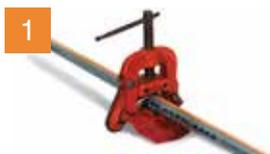
Colocar el tubo a roscar en un tornillo de banco o mordaza sin exagerar el ajuste para evitar ovalamiento, pues esto provocaría una rosca imperfecta. Al realizarlo proteger el tubo de PVC de los dientes del tornillo de banco o mordaza empleando para ello una lija o tela gruesa.
