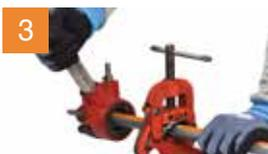
Para elaborar la rosca usar tarraja con dado para rosca NPT (Cónica), correspondiente al diámetro del tubo. Luego realice la limpieza de la rosca y compruebe en seco roscando el tubo con el accesorio a instalar.
