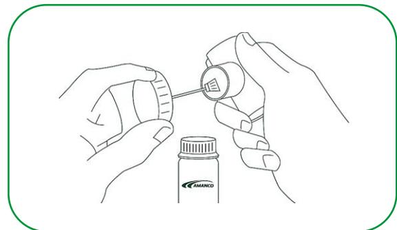
5º Por fim, encaixe a conexão firmemente no tubo, dê 1/4 de volta e mantenha a junta sob pressão por aproximadamente 30 segundos, até que o adesivo adquira resistência. Remova o excesso com um pano e deixe secar.
