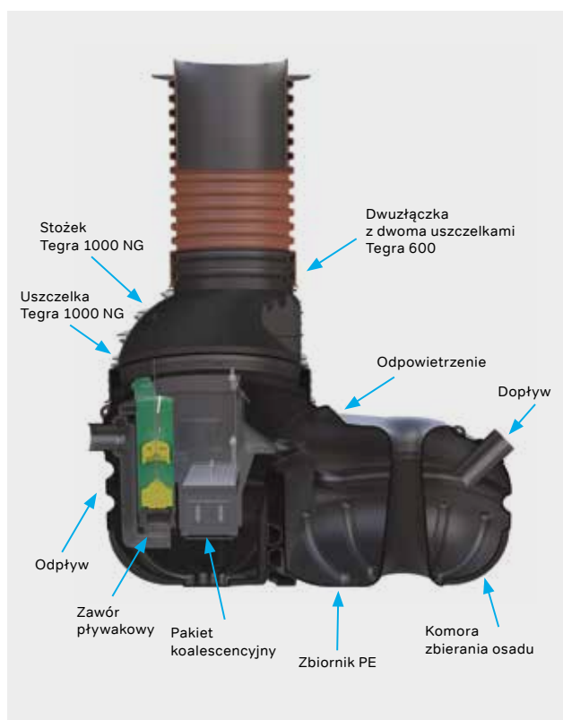
Rys. 16.2.1. Budowa separatora Wavin Certaro NS.
