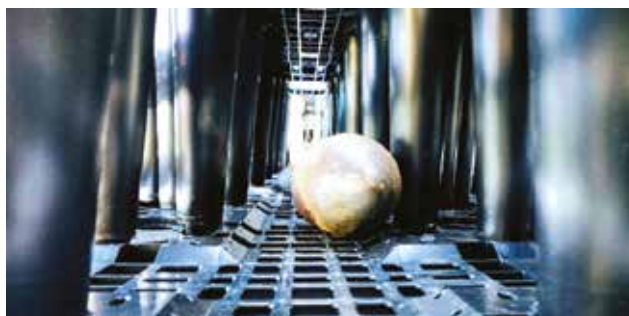
Rys. 9.2.3. Czyszczenie systemu Wavin AquaCell 400.
