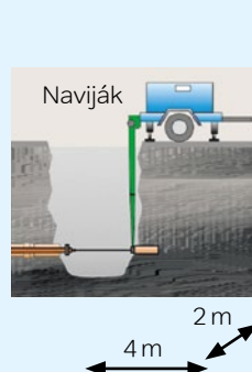
Koncový výkop během zatahování potrubí
