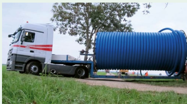
Speciální Jumbo návín pro dopravu velkých délek navinutých přímo z výroby
