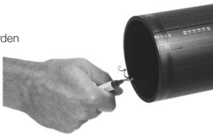
Afbeelding 49 Leidingen ontbramen als een zaag wordt gebruikt
