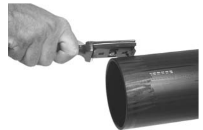
Afbeelding 51 Buiseinde schrapen met een handschraper
