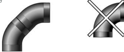
Afbeelding 7 Alleen bochten van 45° gebruiken
