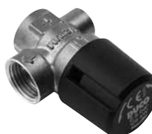
Fig. 34 Danfoss Motor ventil AMV 150 Wavin nr. 4054496 Funktion: Regulere fremløbstemperatur på varmekredsen (med ECL)
