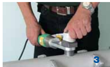
3 Először melegítse meg a furatot. Helyezze a hegesztő idompárt a kifúrt lyukba. Miután egy ráhegesztett darabot készít az adaptere teljes kerülete mentén, tegyen egy műanyag behegesztő nyeret az idompárra úgy, hogy a nyergen lévő jelölés és az adapteren lévő jelölés egy irányban legyen. Melegítse fel a műanyag behegesztendő nyeret. A melegítés ideje megegyezik a 32 mm átmérőjű cső idejével (8 s).
