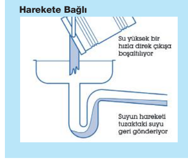
Resim 4) Harekete bağlı sifonların çalışması
