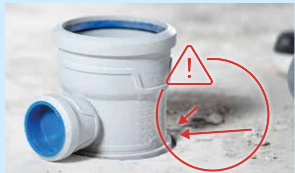
Rysunek 21: Mostek akustyczny utworzony przez gruz budowlany
