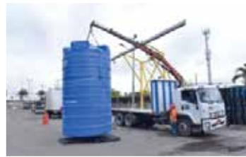
Luego el transportista procede a colocar las fajas certificadas alrededor y por encima del tanque formando un amarre seguro para izar el tanque con el brazo hidráulico, evitando arrastrarlo. Se debe bloquear el acceso de personal alrededor del tanque durante este proceso.
