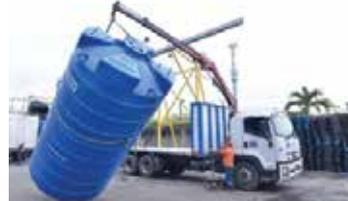
Se recomienda el uso de escaleras a nivel de plataforma para las maniobras de amarre. Evite que el producto se raye, colocando pallets plásticos o lonas de zapatillas para evitar que se golpee asegurando así el buen estado de los productos.
