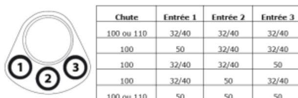
**Figure 2 – Différentes configurations d'entrées possibles**
