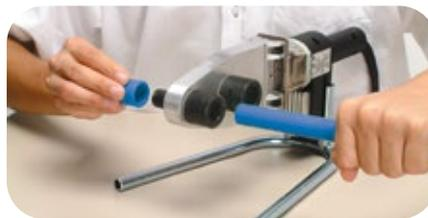
A conexão deve cobrir toda a face macho do bocal e o tubo não deve ultrapassar a marcação feita. Aguarde o tempo de fusão especificado para cada diâmetro.
