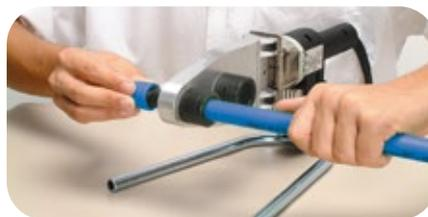
Retire simultaneamente o tubo e a conexão do termofusor quando decorrer o tempo mínimo de aquecimento, conforme tabela de tempo de termofusão no final deste guia.
