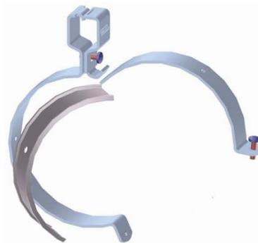
Fig. 1: Schéma collier et demi-coquille métallique
