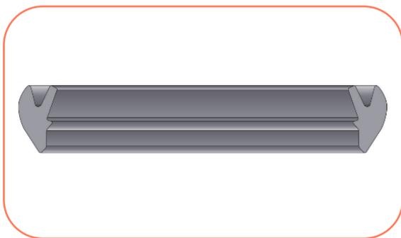
O anel bilabial integrado e removível possui duas funções na execução da junta elástica. O lábio auxiliar é utilizado para limpar a ponta do tubo que está sendo introduzida, eliminando qualquer resíduo que possa interferir na vedação.
