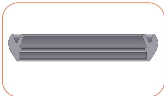
O anel bilabial integrado e removível possui duas funções na execução da junta elástica. O lábio auxiliar é utilizado para limpar a ponta do tubo que está sendo introduzida, eliminando qualquer resíduo que possa interferir na vedação.
