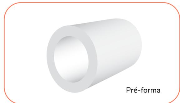
Em seguida, esta pré-forma é aquecida e tem seu diâmetro interno expandido por um pino cônico, ao mesmo tempo em que é estendida axialmente, devido ao controle de velocidade das esteiras. O tubo é então imediatamente resfriado, para manter a orientação.
